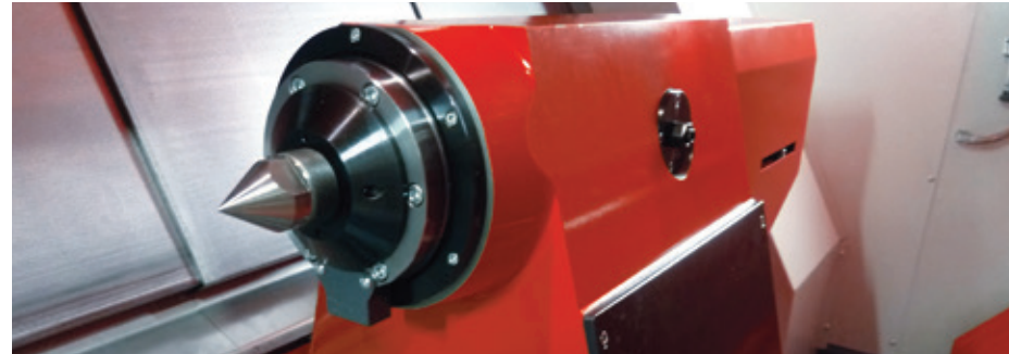
Reitstock mit Pinole mit MK5 oder optional mit MK6, immer mit integrierter Lagerung für stabile Prozessabstützung.
