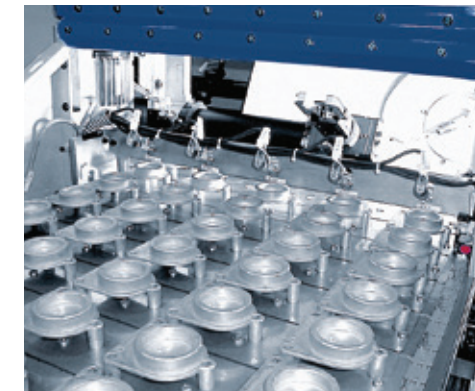
Système d'alimentation par tapis pour chargement de pièces de reprise avec une grande capacité de stockage.
