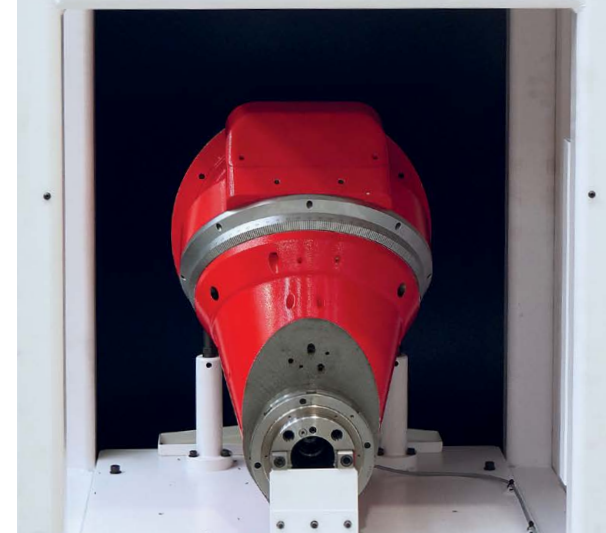
Système de changement de tête entièrement automatique avec possibilité stockage d'un maximum de 4 têtes.
