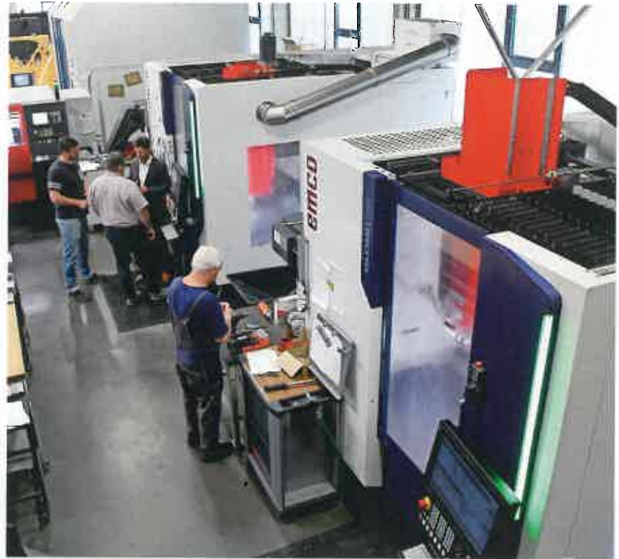
Dreimal Emco: Rechts die beiden Fräsmaschinen Maxxmill und Umill, hinten die schon vorher angeschaffte Drehmaschine E45.
